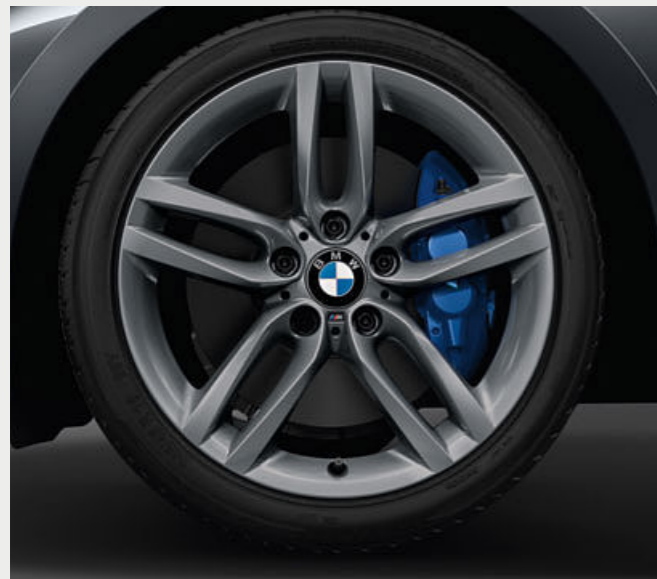
* 18インチ M ライト・アロイ・ホイール・ダブルスポーク・スタイリング 461M (フェリックス・グレー) : (フロント) 7.5J×18ホイール、225/40R18 タイヤ、(リア) 8J×18ホイール、245/35R18 タイヤ (ランフラット・タイヤ) * スノー・チェーンは装着できません。
