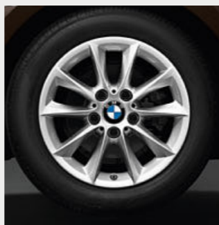
* 16インチ V スポーク・スタイリング 411 アロイ・ホイール : 7J×16ホイール、205/55R16 タイヤ (ランフラット・タイヤ)
